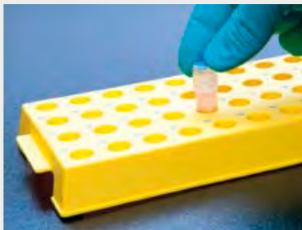
星形底部可防止管子旋转
