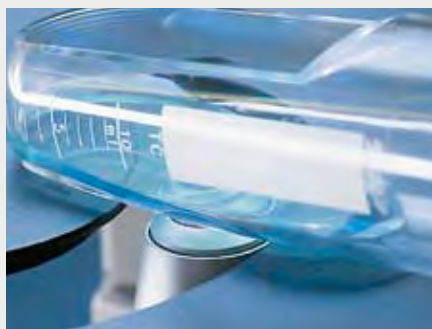
倒置显微镜下的细胞培养扁管
