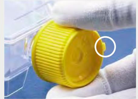
VENT-Position 3 Uhr = luftdicht verschlossen
