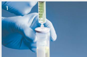
1. Encaixe estável em um tubo de centrifuga de 50 mL
