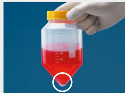
Biorreator 600 após centrifugação
