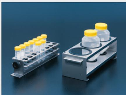
Placas adaptadoras cheias de biorreatores TubeSpin
