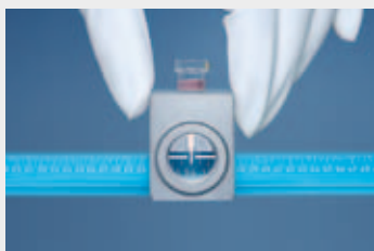
用"easy read" 测量装置对PCV管进行读数
